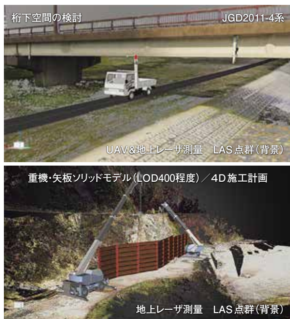
図4. カラー点群(LAS)データ重機・矢板ソリッドモデル(4D施工計画)
